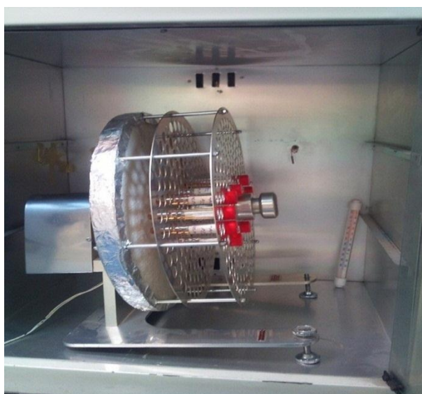
شکل ۳- دستگاه کشت لوله چرخان حاوی لوله های کشت سلولی تلقیح شده در انکوباتور 37^{\circ}\text{C} (۶)
